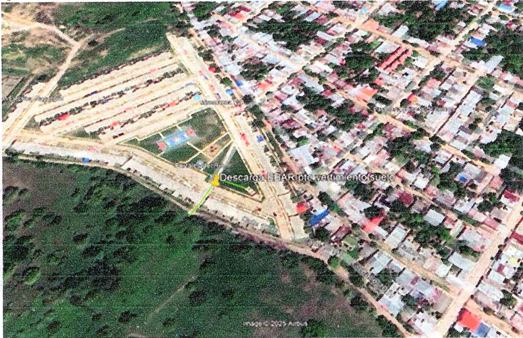
Figura N°9. Trazo de descarga de vertimiento directo al suelo.
